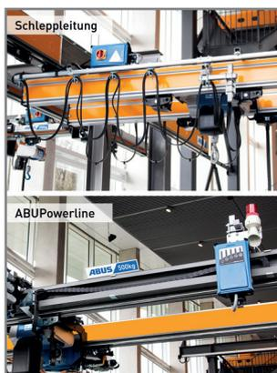
längen oder Hubhöhen schaffen die Voraussetzungen für Ergonomie. Die Bauweise ermöglicht eine direkte Montage am Kranträger. Im Gegensatz zu Schleppleitungen, die einen Kabelbahnhof durch das Anstauen der Leitung an einer Kranträgerseite aufweisen und den Verfahrensweg des Steuerwagens einschränken können, bietet die ABUPowerline einen maximalen Verfahrensweg in beide Kranträgerrichtungen.
