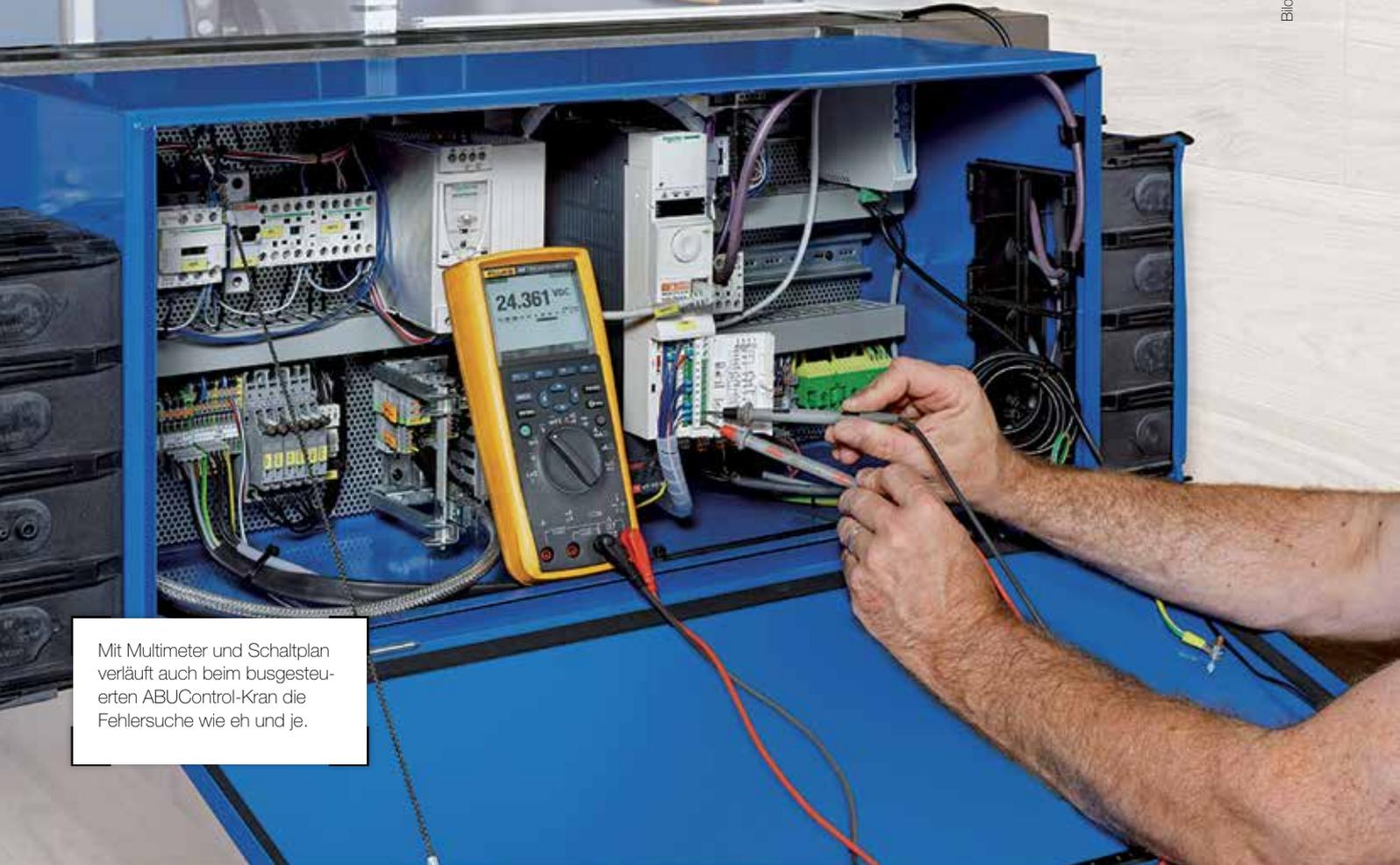
Mit Multimeter und Schaltplan verläuft auch beim busgesteuerten ABUControl-Kran die Fehlersuche wie eh und je.
