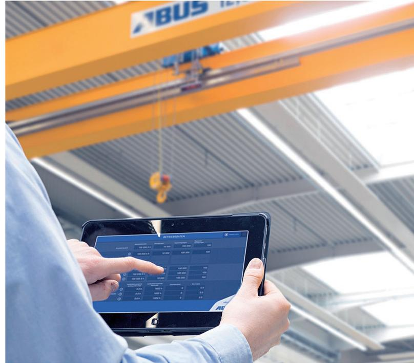
hoben und transportiert, aber von einer einzelnen Steuerung bedient wird, geht es nicht ohne drahtlose Krankontrolle. Hier müssen zusätzliche Steuerbefehle in unterschiedlichen Konstellationen übertragen werden: Während die beiden Krane normalerweise einzeln als unabhängige Maschinen agieren und autarke Steuerungen benötigen, werden sie im Tandembetrieb zu einer gemeinsamen Maschine gekoppelt. Dies ist auch für die sicherheitstechnische Betrachtung der Gesamtanlage von großer Bedeutung.
