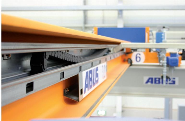
**01** Die Energiekette ABU-Powerline diente Jahrzehnte als Standard bei der verfahrenbaren Steuerung
