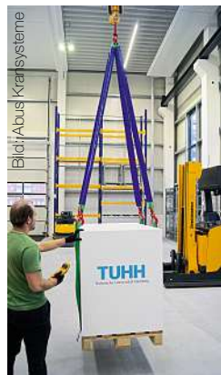
Durch mathematische Berechnungen anhand von Hubhöhe, Fahrgeschwindigkeiten und Anschlagmittellänge berechnet Abucontrol die erwartete Pendelbewegung und steuert aktiv gegen.
