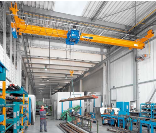
Einschienenlaufkatze der Bauart E an einem Deckenlaufkran EDL
