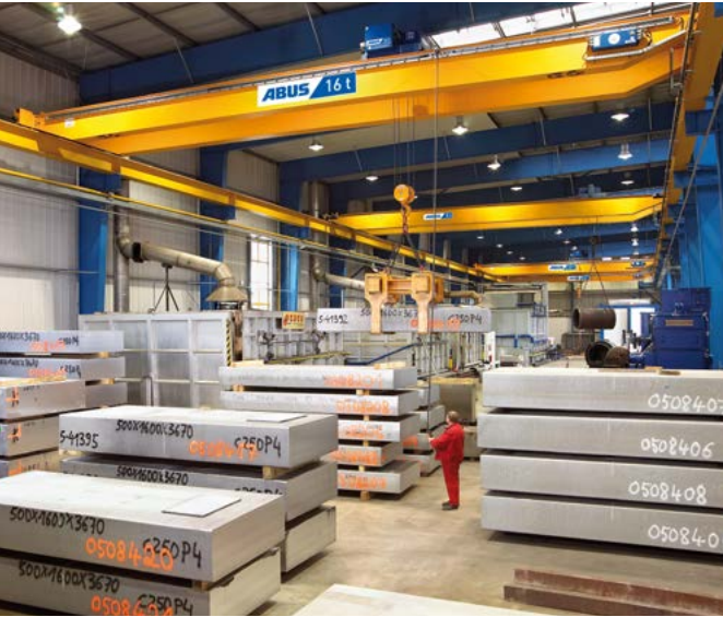
Zweischienenlaufkatzen der Bauart D auf Zweiträgerlaufkranen.
