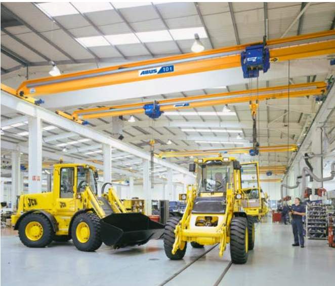
Einschienenlaufkatzen der Bauart E an Einträgerlaufkranen ELV
