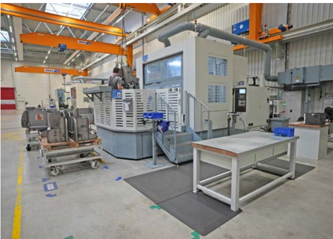
Mechanische Bearbeitung des Seilzug-Gehäuse auf 4-Achsen Fräszentren
