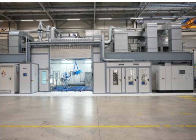
Korrosionsschutz und Oberflächenveredelung auf Basis von Wasserlacken
